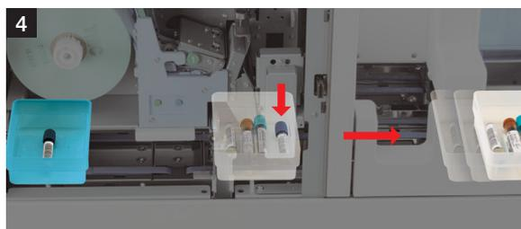
4 Как только все маркированные пробирки помещены в лоток, готовый набор перемещается в переднюю часть системы.
