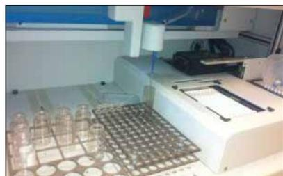
ChemWell® может выполнять иммуоферментный анализ при комнатной температуре или при 37 °С. Инкубатор предназначен для биохимических лунок для обеспечения точных кинетических реакций. Пробоотборник также имеет регулируемую температуру для работы с реагентами при 37 °С. Дополнительный блок охлаждения реагента (RCA) доступен для защиты реагентов от теплоты окружающей среды. Съемные штативы можно хранить в холодильнике, предварительно загружать и готовить к следующему использованию.
