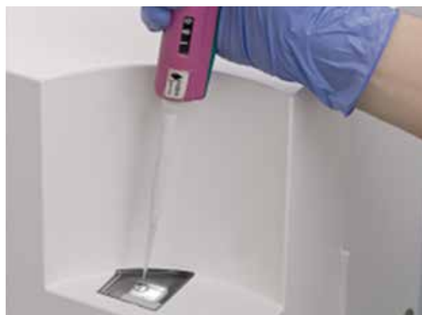
Рисунок 6: Подсветка под прозрачной кюветой, помогает вам вводить наконечник пипетки для быстрой и эффективной работы.
