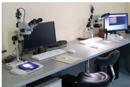
Тринокулярные микроскопы серии EMZ. Через видеосистему изображение выводится на экран компьютера.
