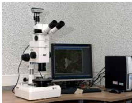
Система для точных научных исследований рельефных, объемных и плоскополированных объектов на базе стереомикроскопа Meiji ZOOM серии RZ-B позволяющего получать четкое изображение с высоким разрешением и без искажения при увеличении от 3,75x до 300x.
