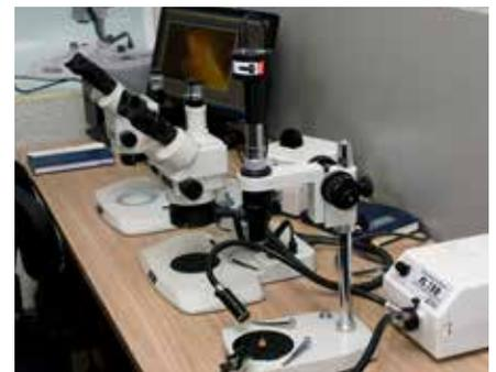
Система для стандартных исследований, отбора и сортировки зерен минералов, микроископаемых, подготовки мономинеральных и моновидовых проб, а также изучение объектов (шлифов) в проходящем свете на базе стереомикроскопов Meiji Techno серии EMZ-5TR при увеличениях 2,1-270x.
