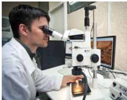
Видеосистема на базе стереомикроскопа RZ.
