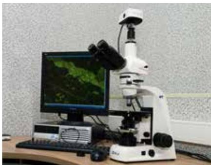
Система для точных научных исследований микрообъектов в проходящем свете с повышенной четкостью изображения на базе поляризационного микроскопа Meiji Techno серии MT9000 и оптики Infinity при увеличениях от 40x до 600x.
