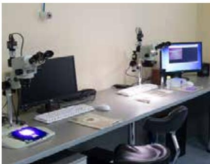
Тринокулярные микроскопы серии EMZ. Через видеосистему изображение выводится на экран компьютера.
